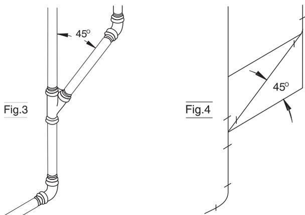
Os tubos fora da horizontal ou vertical são representados por traços com inclinação diferente de 30°, devendo-se marcar no desenho o ângulo real da inclinação do tubo (fig. 3 e 4).
