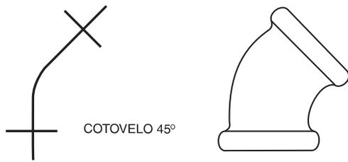
Para facilitar e tornar rápida a representação e leitura de sistemas hidráulicos, utilizam-se símbolos para a representação dos diversos componentes.
